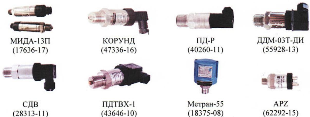
Рисунок 4 – Преобразователи избыточного давления
