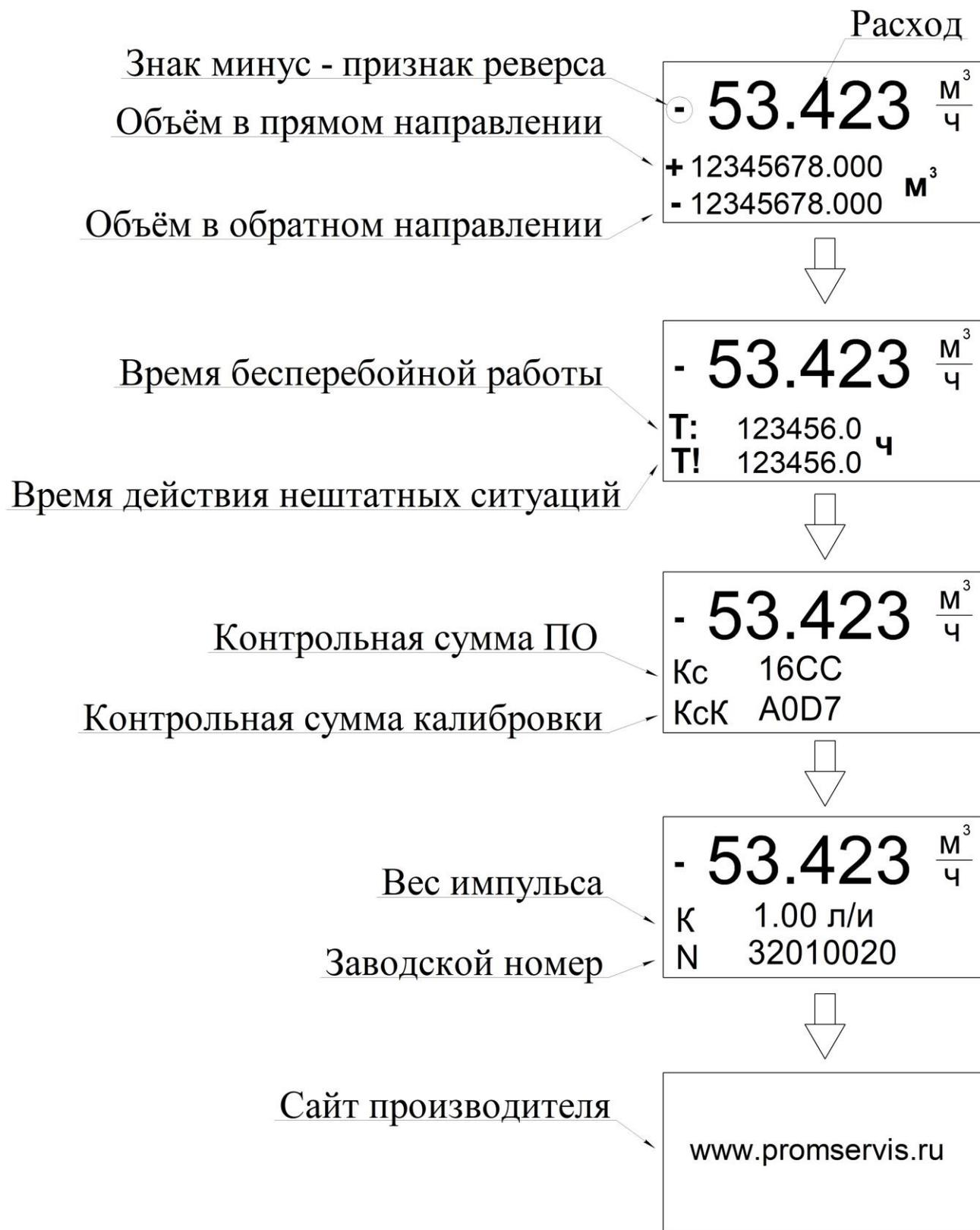
Рисунок 2 – Пример отображения информации на индикаторе
