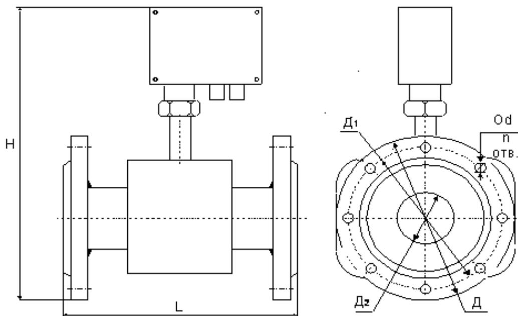
Рисунок В.1 - Габаритные и присоединительные размеры преобразователей
