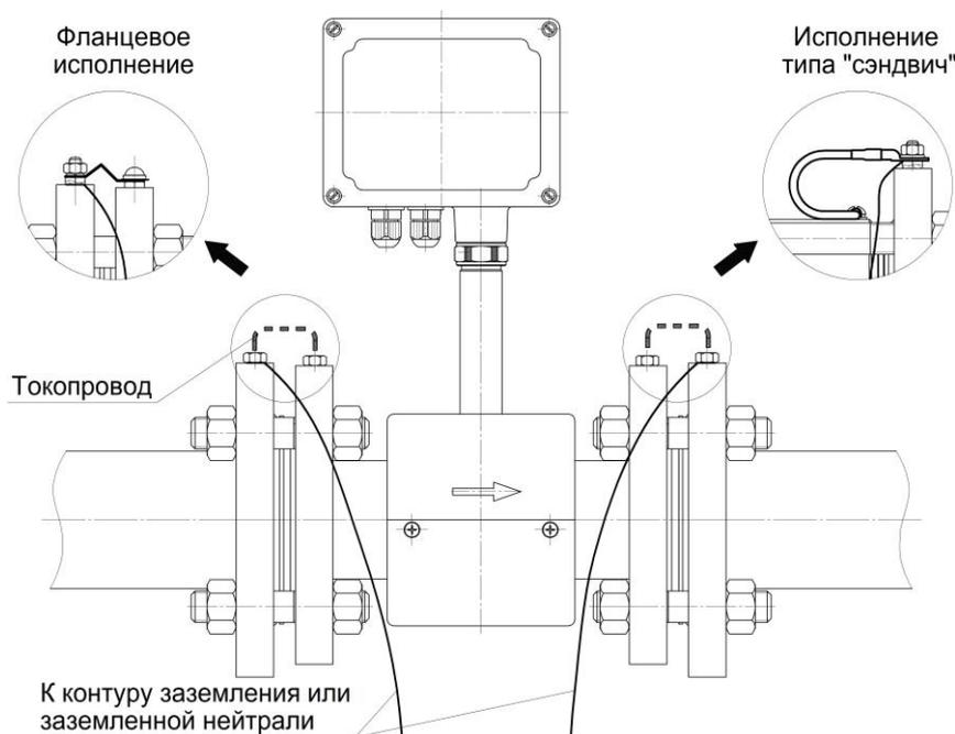
Рисунок 2 – Подключение фланцев преобразователя к заземлению
