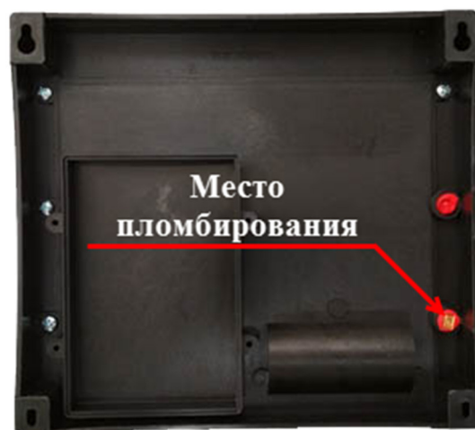
Рисунок 9 – Пломбирование тепловычислителя СПТ944
