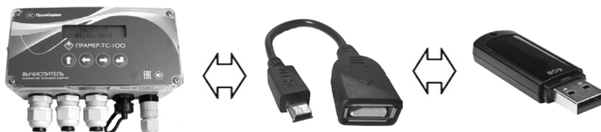
Рисунок 8 – Подключение USB Flash накопителя
